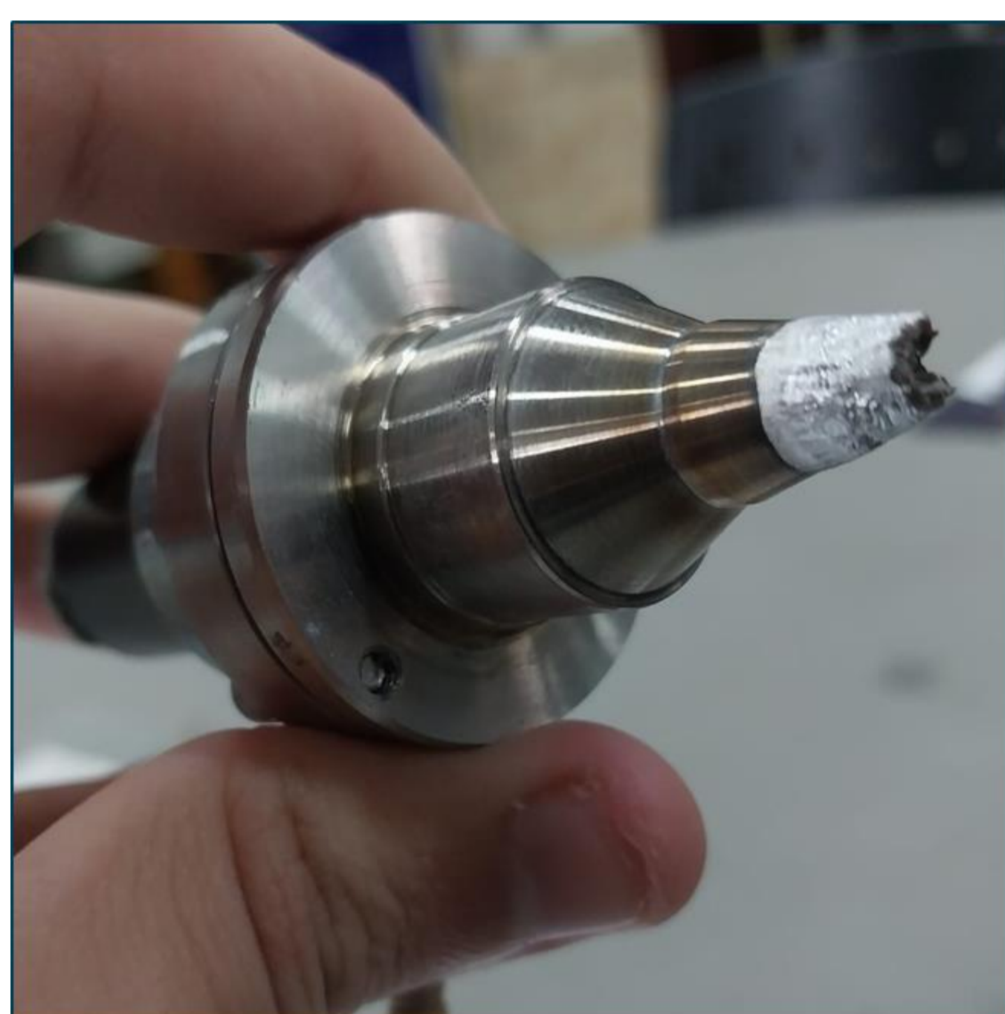
Figura 2 – Fraturas na ponta do bocal
